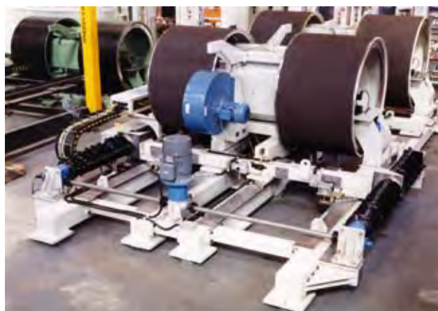
Banco di prova a rulli per l'automotive, installato sopra livellatori Bolt-Through (SCT)
