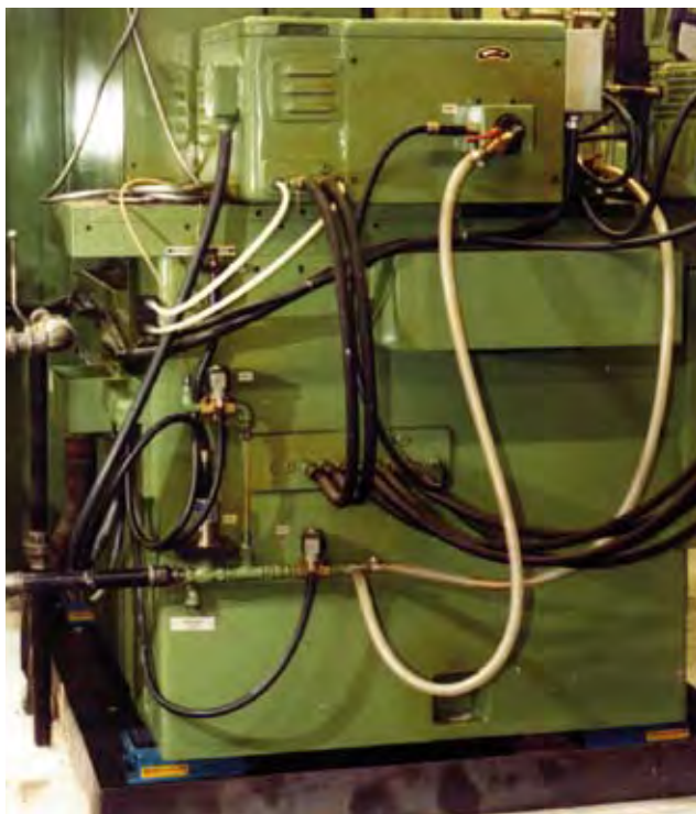
Pressa idraulica, installata sopra livellatori a cuneo Freestanding (SCF)
