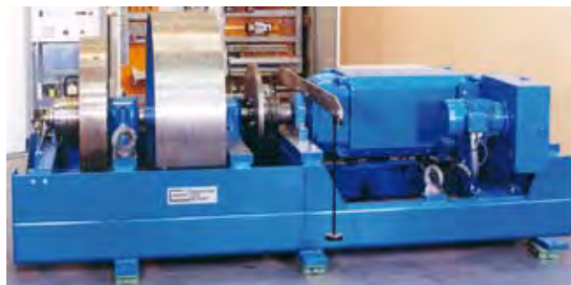
Dinamometro per motori elettrici, installato sopra livellatori a cuneo Freestanding (SCF)
